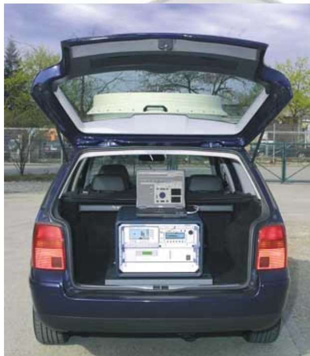
R&S TMS 200 mit Optionen in einem Fahrzeug eingebaut
