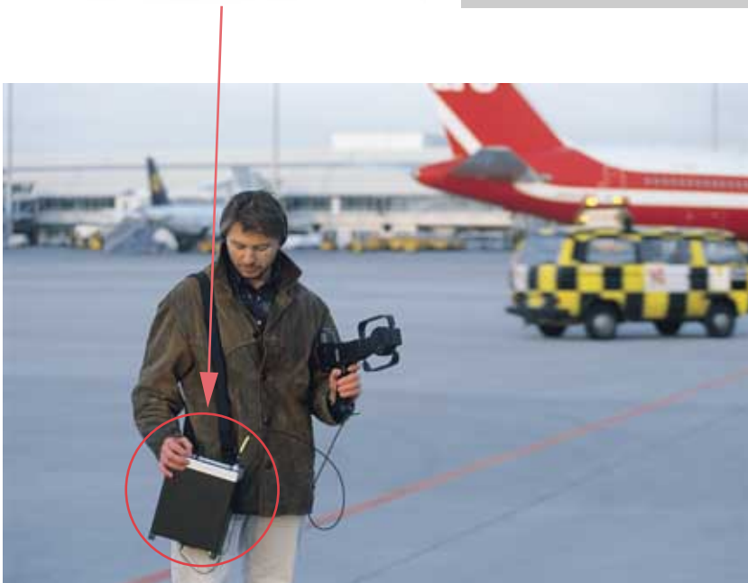
Entnahme des Empfängers und Verwendung als portables Überwachungssystem
